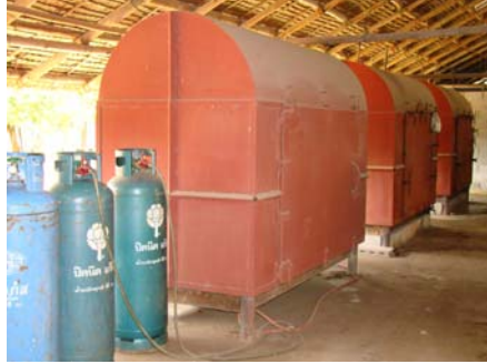
นำถุงจี๋เลื้อยไปนึ่งฆ่าเชื้อด้วยหม้อนึ่งความดัน
